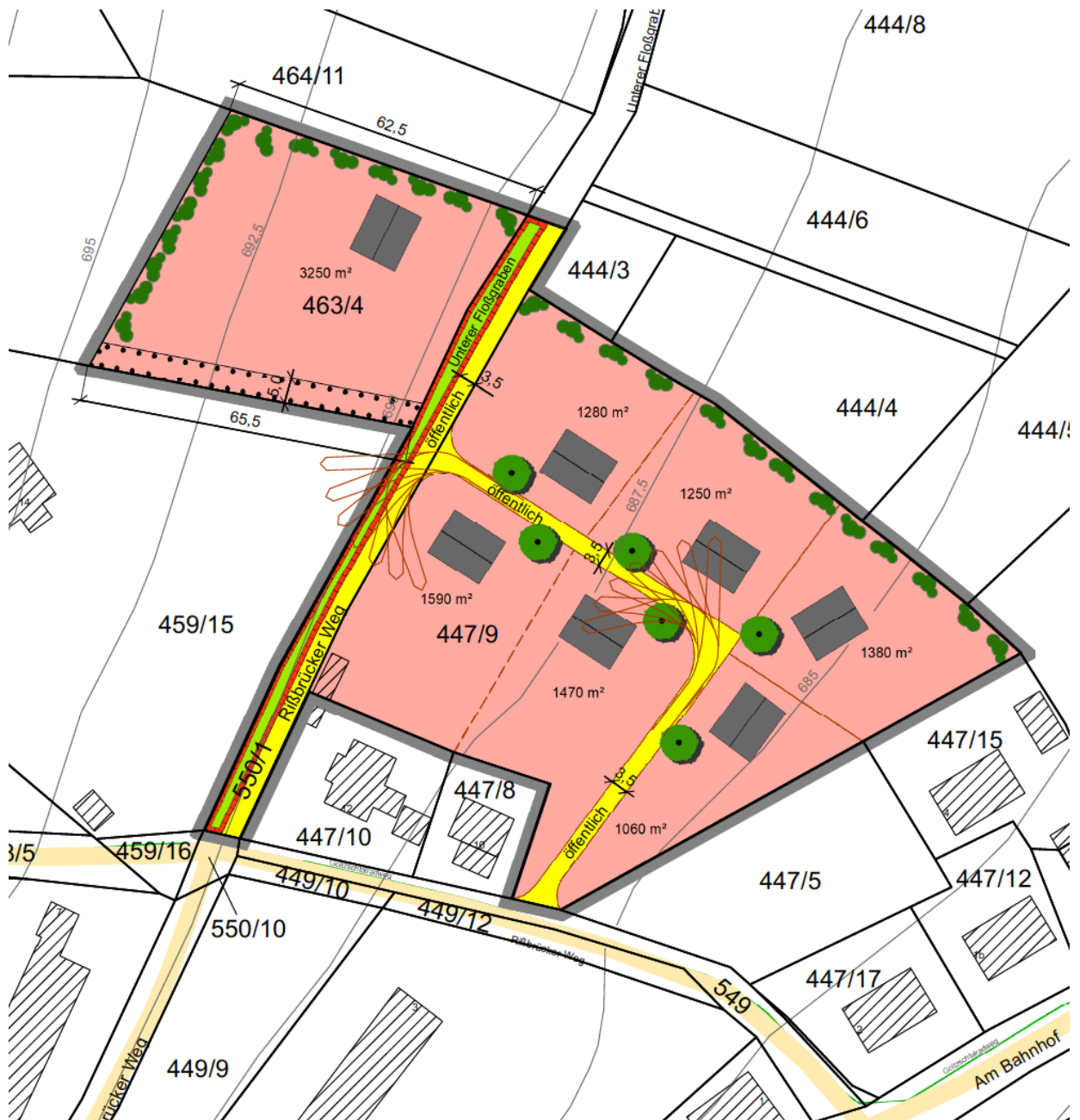
Abb. 10: Städtebauliches Konzept für das Wohngebiet „Am Unteren Floßgraben“, Beispiel einer lockeren Einfamilienhausbebauung, Stand 08/2022
